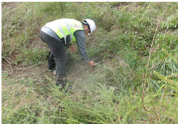
절리면 경사/경사방향 측정
